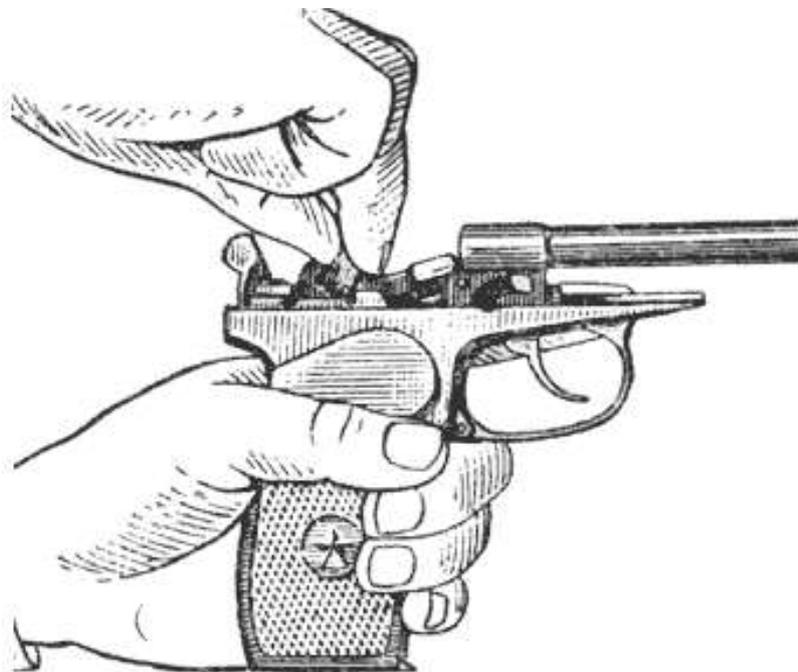
**Рис. 10. Отделение шептала и затворной задержки от рамки**
