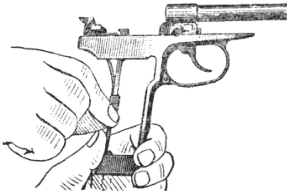
**Рис. 23.Закрепление боевой пружины задвижкой**
