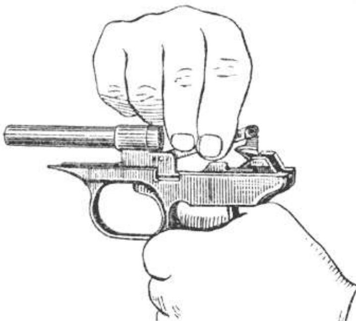
**Рис. 14. Отделение спусковой тяги с рычагом взвода от рамки**
