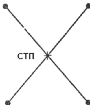
**Рис. 50. Определение средней точки попадания по четырем симметрично расположенным пробоинам**
