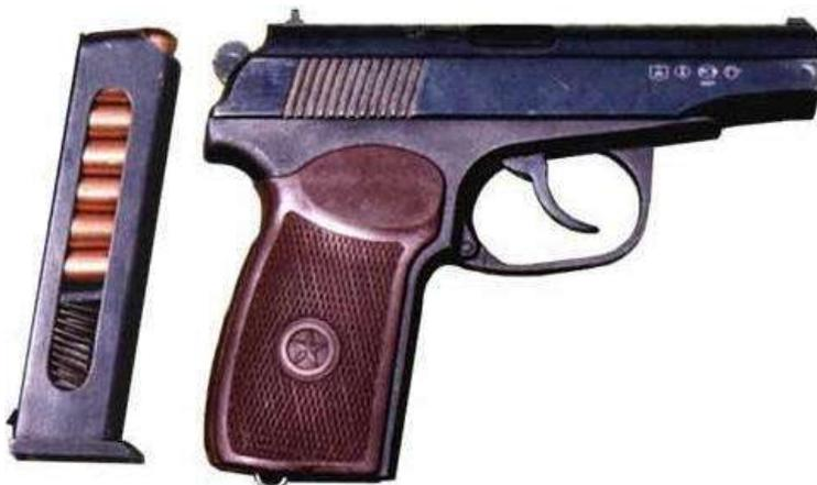
Автоматика пистолета действует на основе отдачи свободного затвора, выполненного в виде подвижного кожуха ствола. Возвратная пружина затвора надевается непосредственно на ствол. Ударный механизм куркового - типа С с открытым курком и двуперой боевой пружиной, расположенной в рукоятке позади магазина.
